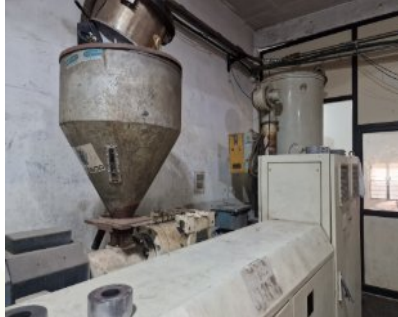
Eine ausgemusterte Fertigungsanlage der israelischen Firma NetaFim. Granulat wird eingefüllt.
