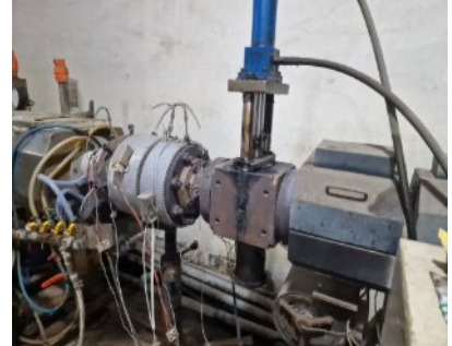
Mit hohem Druck wird das geschmolzene Granulat in eine Schlauchform gepresst.
