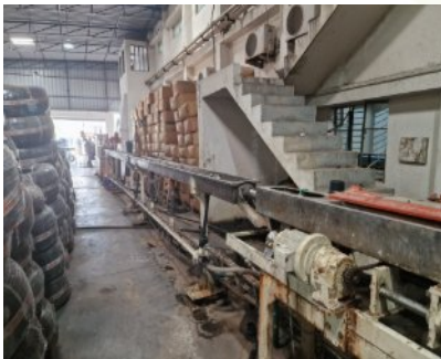
Über ein Wasserbad wird der ausgepresste Schlauch gekühlt, Löcher gestanzt und automatisch aufgewickelt.
